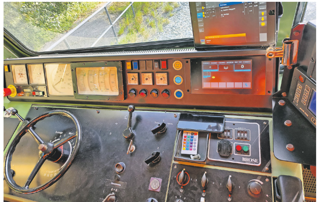
Der Testzug der SOB mit eingeschaltetem ATO-System (Automatic Train Operation).
